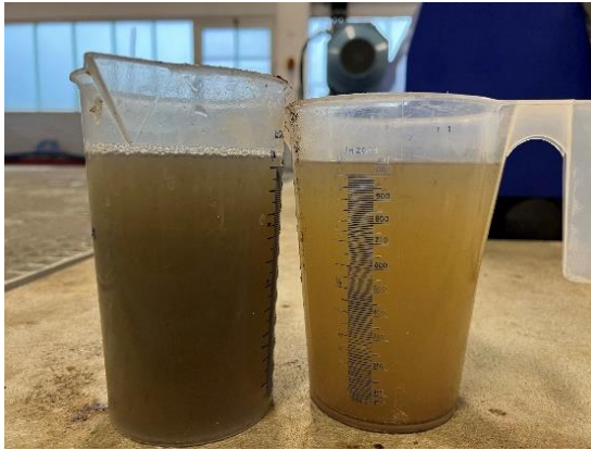
Bild 6: Zentrwasserprobe mit Unterdosierung
