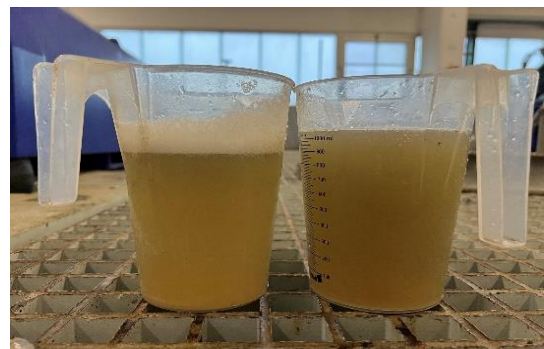
Bild 5: Zentratwasserprobe mit Überdosierung
